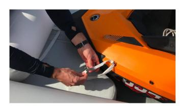
Gonfiare il sedile tubolare anteriore e fissarlo con la cinghia sul fondo o sul lato in base alle predisposizioni sullo scafo principale.
